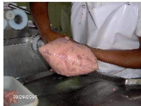
Figura 14 – Embutimento do produto tipo presunto cozido
