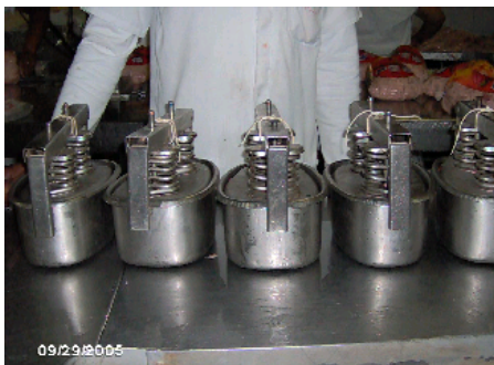
Figura 15 – Formas de produto tipo presunto cozido prontas para cozimento
