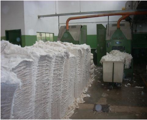
FIGURA 1 – Algodão *in natura* submetido a processos de retirada de impurezas.
