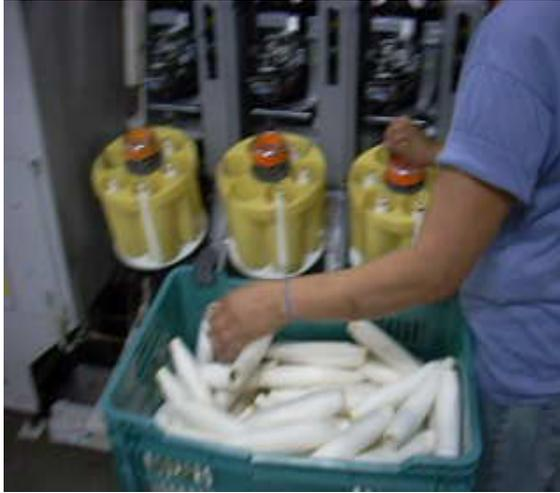
**Figura 14 – Colocação de espula com uso do punho.**
