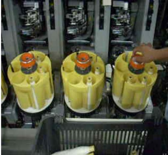
Figura 12 – Colocação de espula com uso dos dedos
