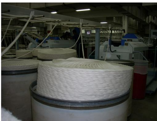
FIGURA 4 – Rolos de mantas transformados em rolos de fitas.
