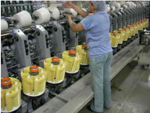
FIGURA 16 – Atendimento à luz verde acesa: retirada de bobina pronta.
