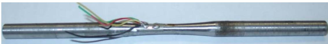
FIGURA 4.24 – Corpo-de-prova instrumentado com extensômetro elétrico.
