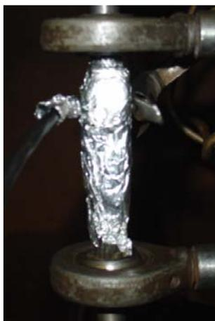
FIGURA 4.25 – Corpo-de-prova com extensômetro e revestido com massa plástica.
