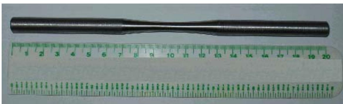
FIGURA 3.13 - Foto do corpo-de-prova utilizado nos testes de fadiga flexo-rotativa.
