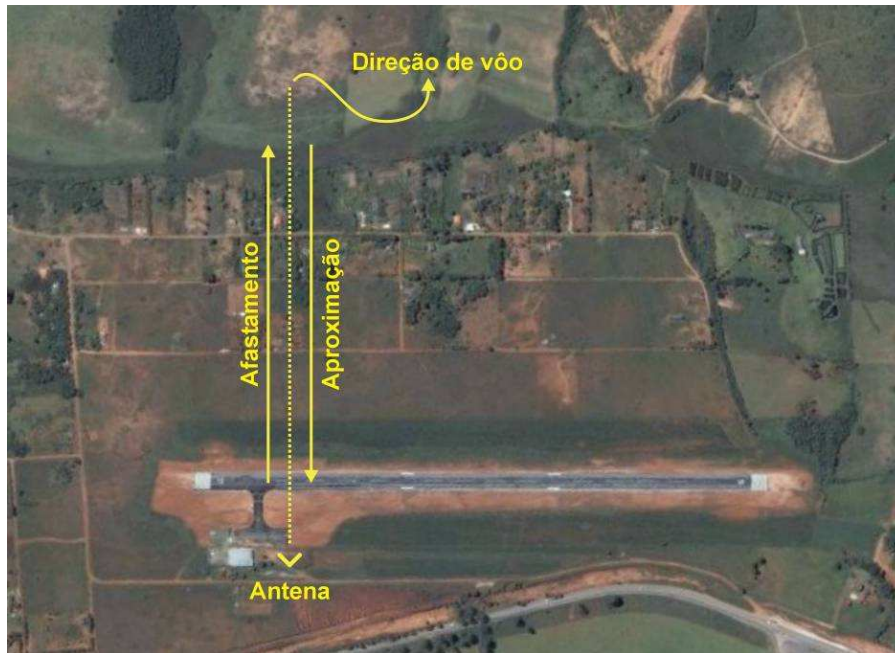
Figura 4.8. Procedimento para o ensaio de atenuação em função da distância
