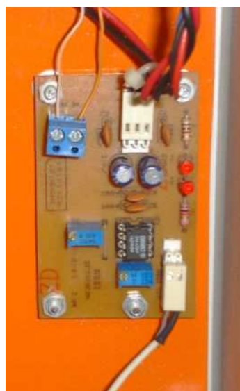
Figura 3.15. Amplificador de diferenças implementado
