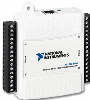
Figura 3.10. Conversor A/D utilizado para amostrar o sinal de RSSI
