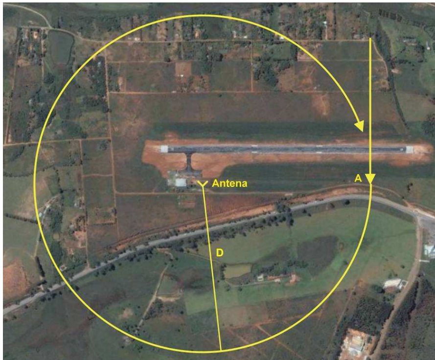
Figura 4.7. Procedimento para obtenção do diagrama de radiação da antena instalada na estação de solo
