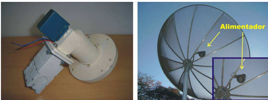
Figura 3.40. Alimentador utilizado em antenas parabólicas
