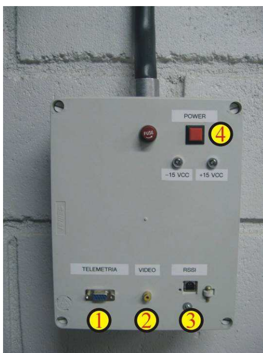
Figura 3.30. Caixa de telemetria: 1 – Conector de telemetria; 2 – Saída de vídeo; 3 – Conector para o sinal de RSSI; 4 – Chave para ligar e desligar o equipamento
