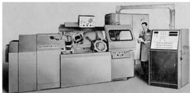
**FIG. 2.6- Centro de usinagem CNC com 16 ferramentas da Cincinnati Milacron- Fonte ASM (1999)**
