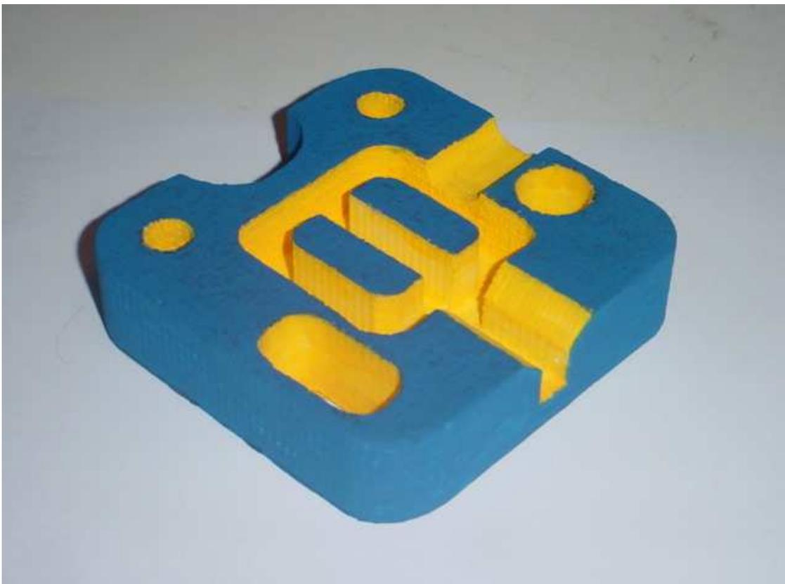
**FIG. 4.26**–Protótipo físico final obtido através da aplicação prática do programa *AutoCAM* .
