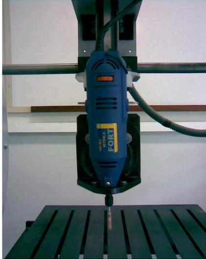
**FIG. 4.16–** Micro-retífica utilizada como ferramenta de corte da máquina de comando numérico.
