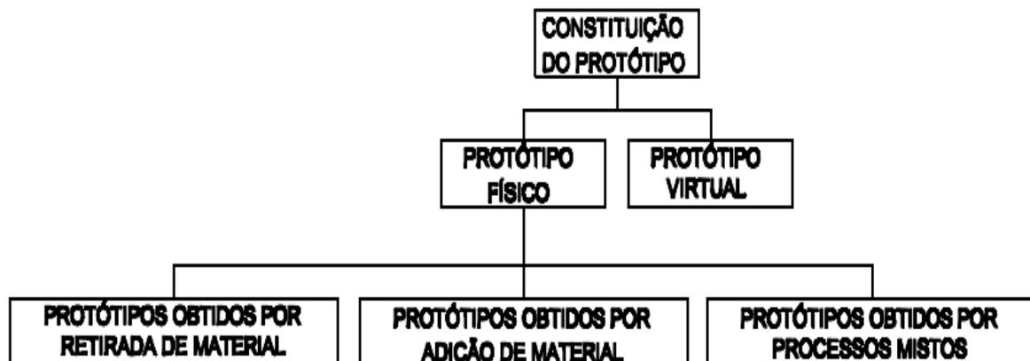
FIG 2.1: Classificação dos protótipos
