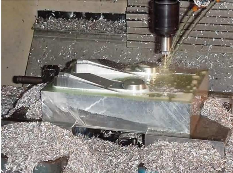
**FIG. 2.2: Fabricação de uma peça utilizando a técnica de prototipagem por retirada de material**
