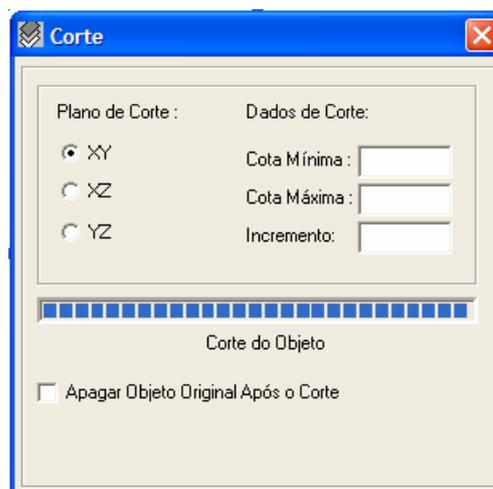
FIG. 3.2- Tela da interface com os parâmetros de entrada para o usuário do *software 3DFORM 2.0*
