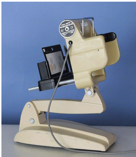
FIGURA 3.30 - Equipamento desenvolvido por Mast e Gannet em 1948 e vendido pela empresa Keystone View. Tem o mesmo princípio de funcionamento do equipamento desenvolvido por Sherman em 1935. FONTE - http://www.pemed.com/
