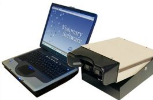
FIGURA 3.35 - Equipamento CVS-V GT produzido pela Keystone View. Apesar de ser controlado por um computador ainda apresenta o mesmo designer da patente de Griffin (1986).
