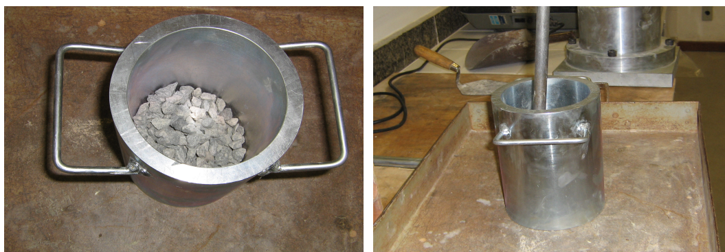
Figura 4-13 - Determinação da amostra inicial (Mi).
