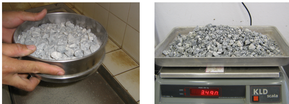
Figura 4-15 - Peneiramento e aferição da massa final ( M_f ).
