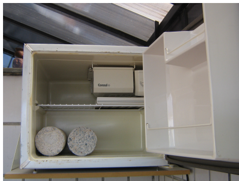
Figura 4-32 – Corpos-de-prova submetidos à refrigeração e aquecedor elétrico.
