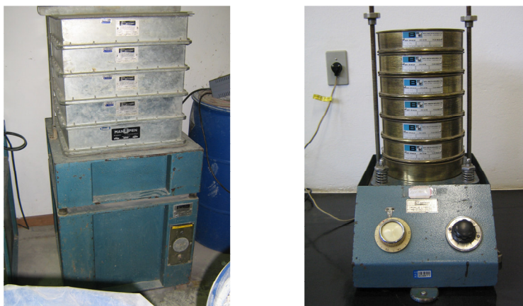
Figura 4-7 - Sistema vibratório de peneiras metálicas para agregados graúdos e miúdos.
