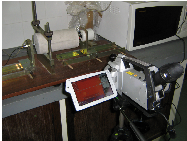
Figura 4-30 – Imagem termográfica da frequência ressonante longitudinal.
