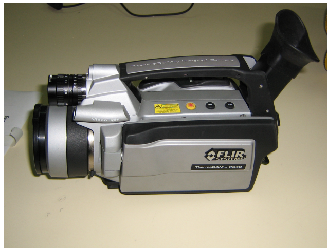
Figura 4-29 - Termocâmara Flir - P640.
