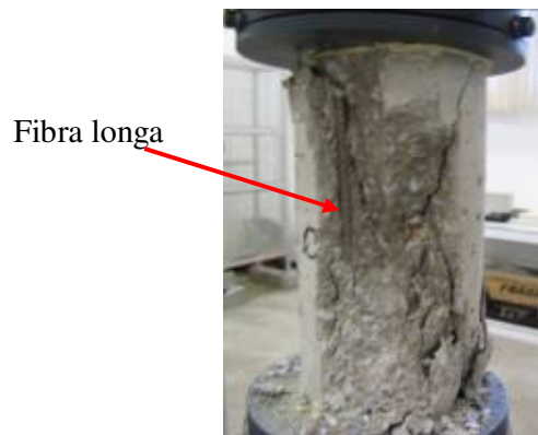
Figura 5-13– Corpo-de-prova rompido contendo fibras longas.
