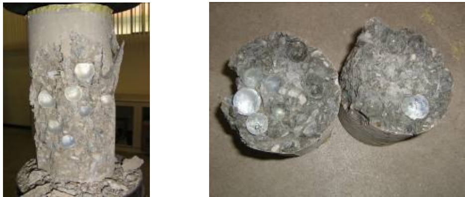
Figura 5-8– Corpo-de-prova rompido contendo bolas de vidro.
