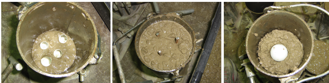
Figura 4-18 - Inclusão de imperfeições e barras de aço.
