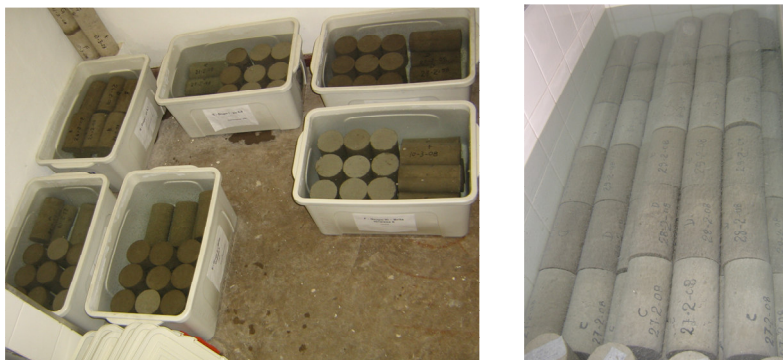
Figura 4-20 – Cura dos corpos-de-prova.
