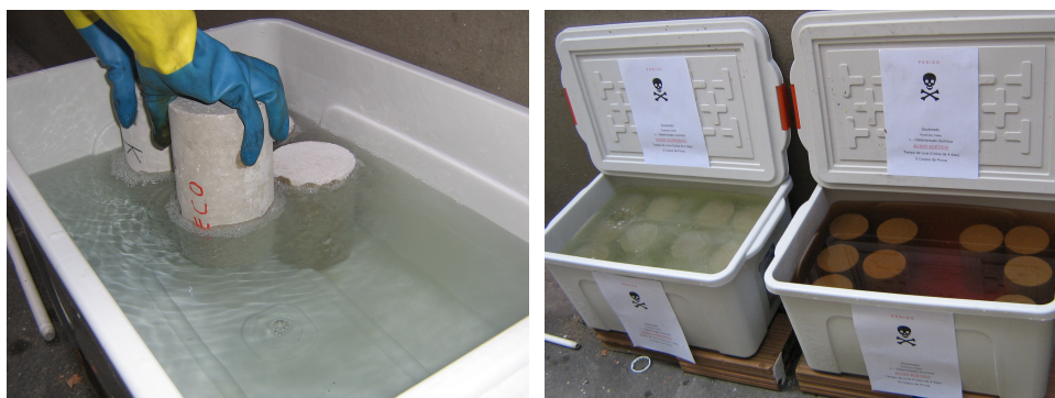
Figura 4-23 - Deterioração química de ácido clorídrico e acético.
