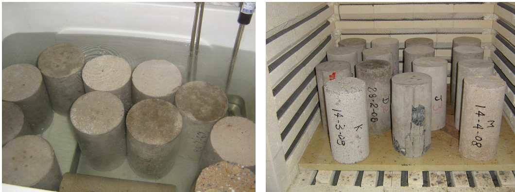
Figura 4-31 – Corpos-de-prova submetidos ao aquecimento em água quente e calor de forno de mufla .
