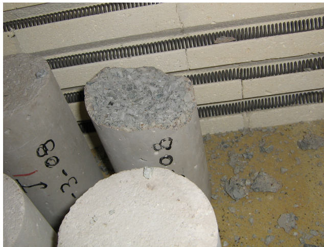
Figura 4-22 – Corpo-de-prova danificado após aquecimento a 354°C.
