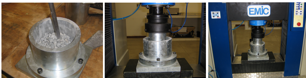
Figura 4-14 - Procedimento do ensaio de esmagamento.
