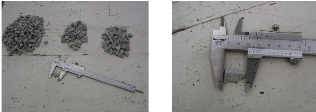
Figura 4-10 - Índice de forma do agregado.
