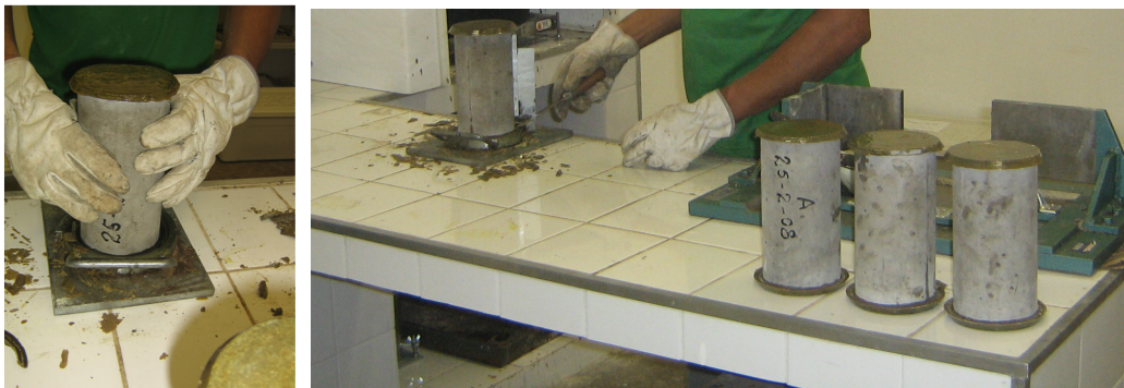
Figura 4-24 - Capeamento dos corpos-de-prova por enxofre.
