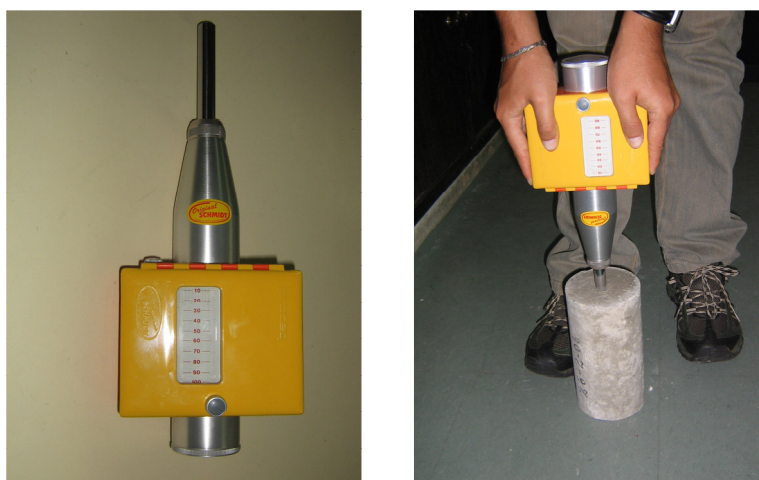
Figura 4-26 – Esclerômetro Schmidt - Ensaio de esclerometria.
