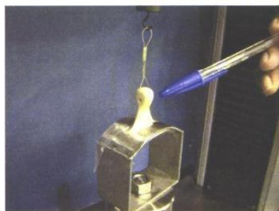
Figura 2 – Montagem do protótipo na máquina de ensaios
