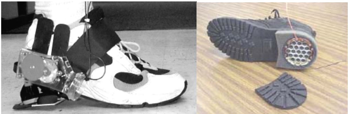
FIGURA 1 – Exemplos de geradores magnético e eletrostático acoplados a calçados.
