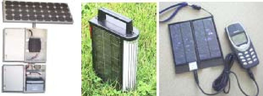
FIGURA 7 – Carregamento de rádio e telefone celular por meio da energia solar.
