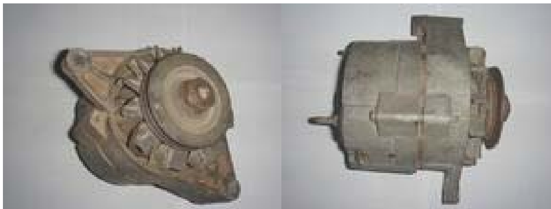
FIGURA 5.1 - Alternador automotivo considerado como alternativa à conversão da energia mecânica.
