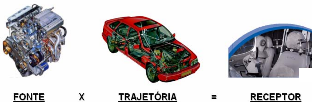
FIGURA 1.1 – Esquema do processo de percepção do ruído em veículos
