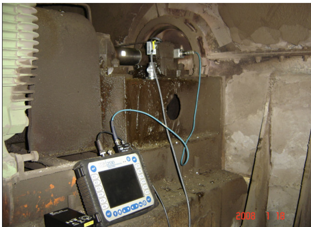
FIGURA 3.21 – Montagem do Instrumento de Medida e Foto-tacômetro
