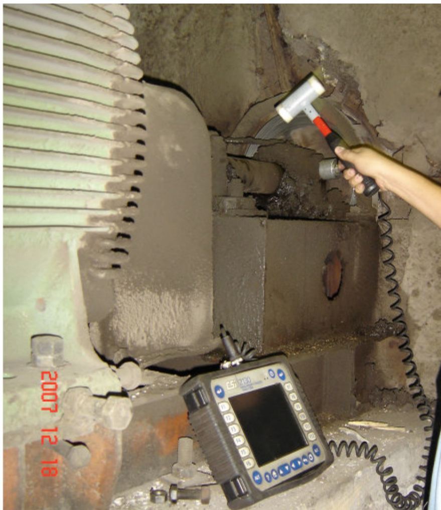
FIGURA 3.20 – Analisador CSI 2130 e Martelo utilizado no Teste de Batida
