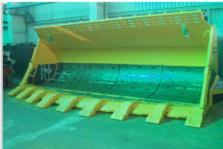
FIGURA 1.2. Aplicação de placas resistentes ao desgaste abrasivo, em equipamento industrial utilizado para movimentação de minério de ferro. (Eutectic, 2000).
