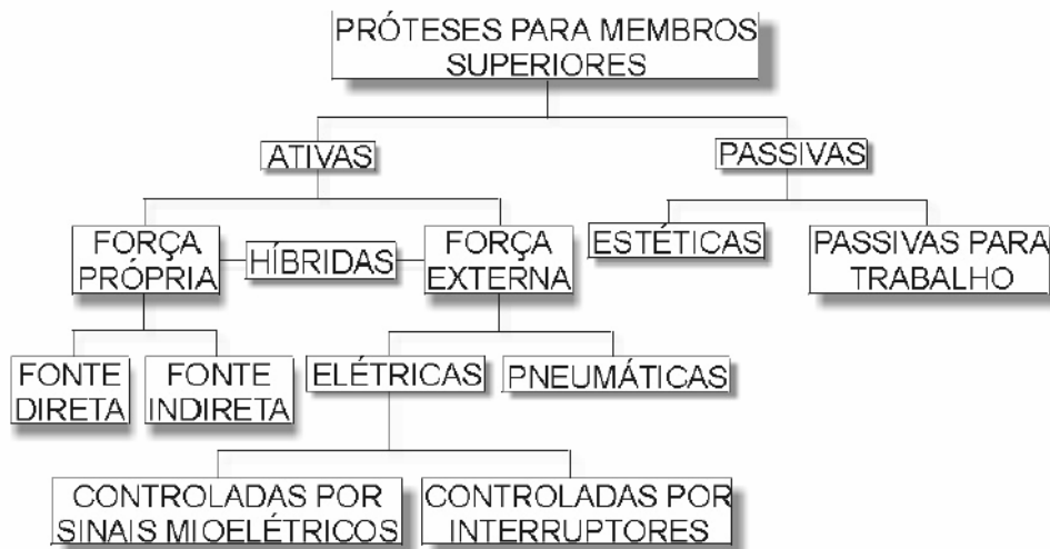
FIGURA 2.1. Proposta da Otto Bock Industry, para classificar próteses de mão através da fonte de energia. FONTE- CUNHA, 2002, p. 22
