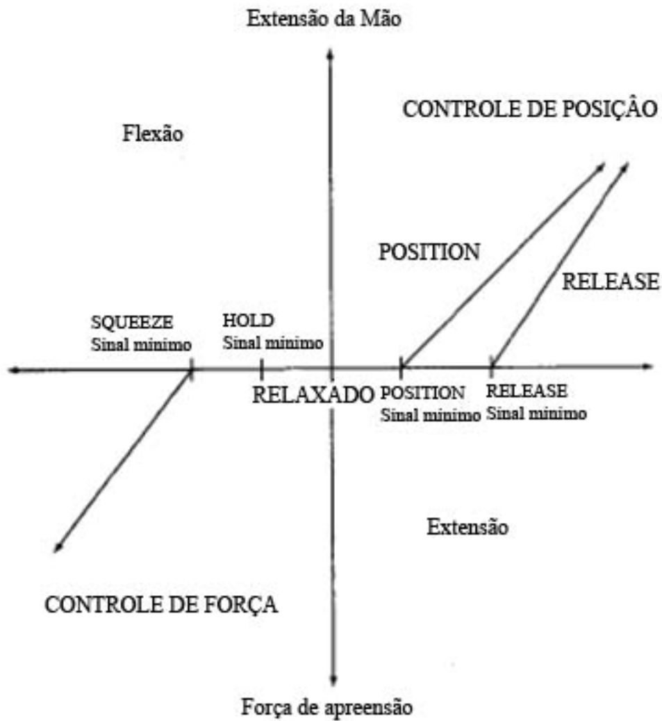
FIGURA 2.20 Esquema de controle do sinal EMG da MARCUS Hand. FONTE- Adaptado de (KYBERG, 1995).
