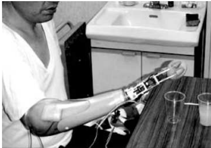
FIGURA 2.21 A Osaka Hand segurando objetos frágeis. FONTE- (RYUHEI, 2005)
