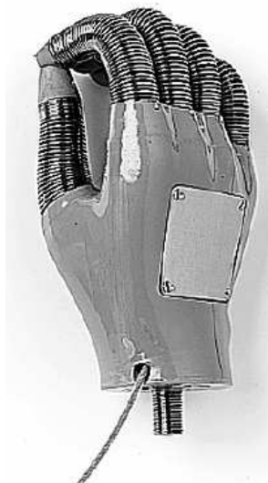
FIGURA 2.6. Exemplo de uma prótese de mão ativa de força própria de fonte indireta que possui um fator estético.
