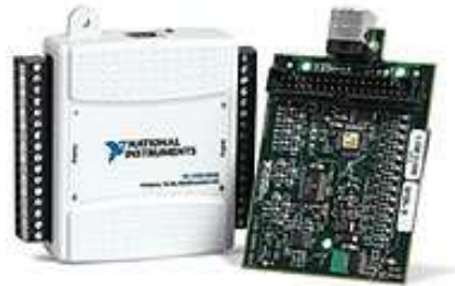
FIGURA 3.13. A placa de aquisição. USB-6009 da National Instruments. FONTE- www.ni.com (05/2007)
