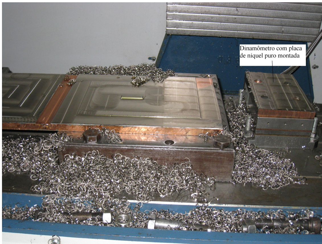
Figura 3.12 Montagem da placa de cobre com níquel eletrodepositado e dinamômetro
