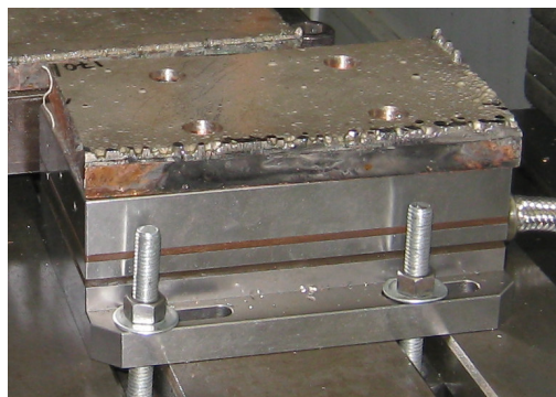
Figura 3.4 Placa de cobre com níquel eletrodepositado montada sobre o dinamômetro
