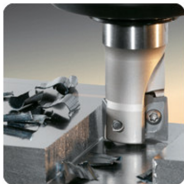
Figura 2.2 Fresamento de topo reto (a) e Fresamento de topo esférico (b)
