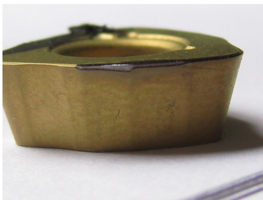
Figura 4.35 Arestas de corte principal e secundária do inserto utilizado na fresa com \chi_r = 12^\circ , a_p = 0,5 mm e v_c = 70 m.min -1 (CVD)
