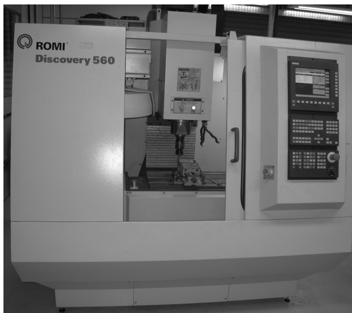
Figura 3.7 Centro de usinagem Romi Discovery 560 com comando Siemens 810D
