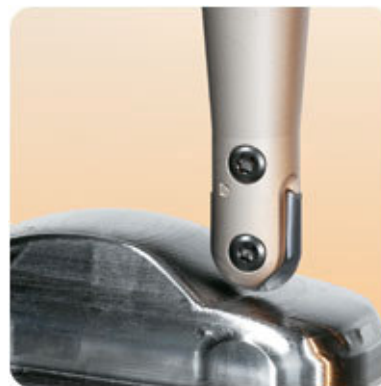
Figura 2.2 Fresamento de topo reto (a) e Fresamento de topo esférico (b)
