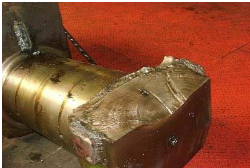
FIGURA 3.2 - Detalhe da fratura ocorrida no eixo virabrequim.
