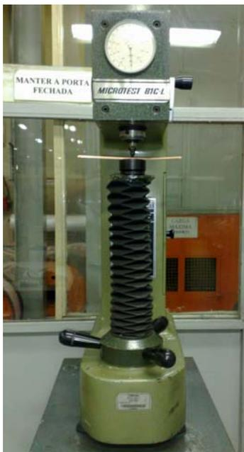
**Figura 3.12 – Máquina de ensaio de dureza**
