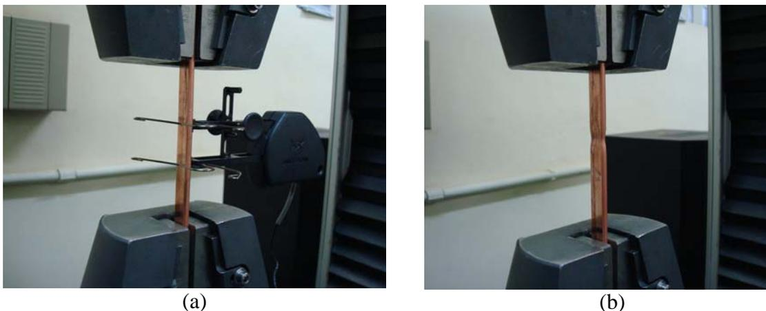
**Figura 3.11 – Ensaio de tração do material laminado: (a) Vista geral e (b) Detalhe da região de estricção do material**
