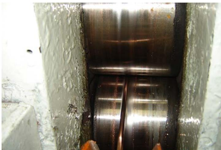
**Figura 3.2 – Processo de laminação do vergalhão de cobre**
