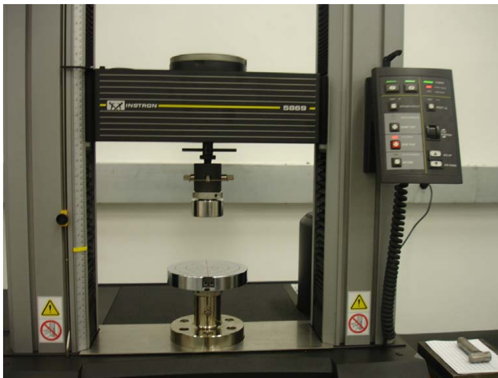
Figura 4- Máquina universal de ensaios, tipo eletromecânica, marca INSTRON, modelo 5869, série 5869 P8823
