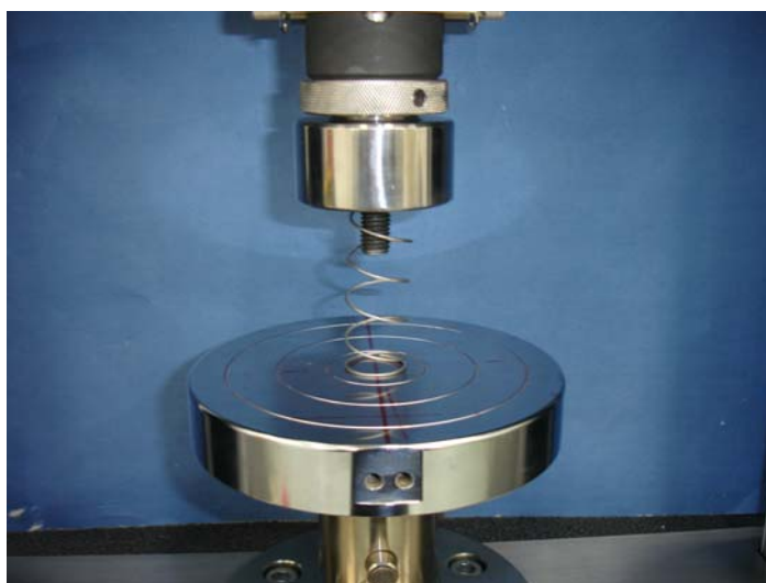
Figura 10: Ensaio de verificação de propriedades da mola.
