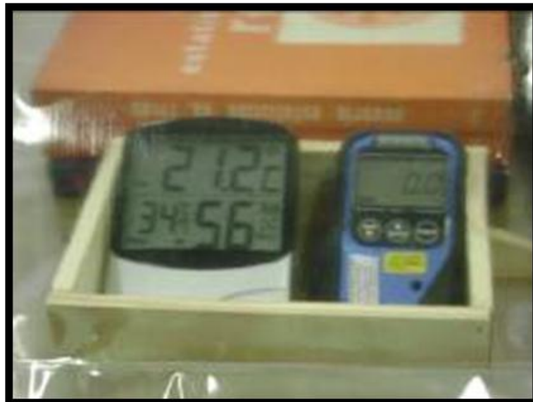
Figura 19 - Acervo documental da extinta RFFSA. Desinfestação por anóxia ou atmosfera modificada. Equipamentos de medição.
