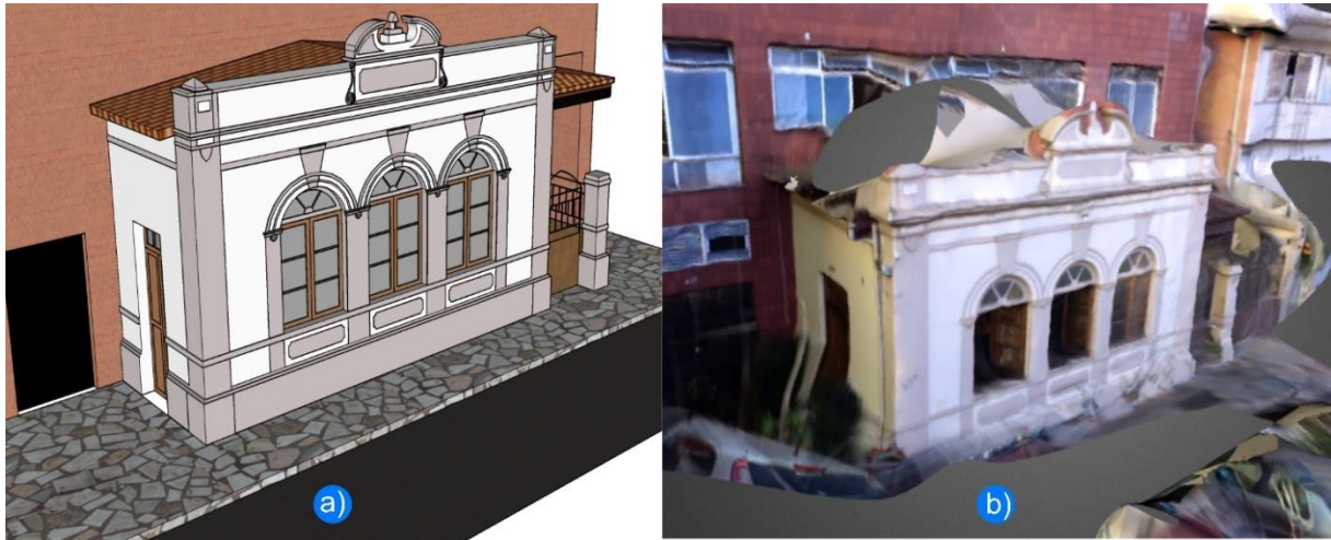
Figura 35 - Comparativo entre digitalizações tridimensionais de edifício tombado em Belo Horizonte
