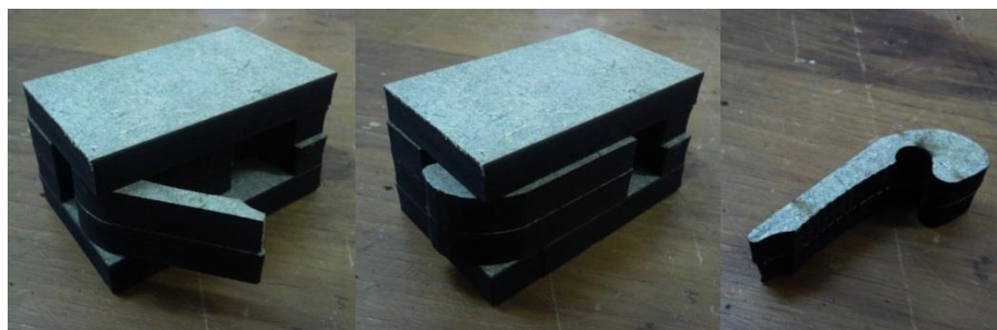
Figura 76 Protótipo, cortado a laser, da primeira ideia de fixadores por pressão para os painéis. Fonte: elaborada pelo autor.
