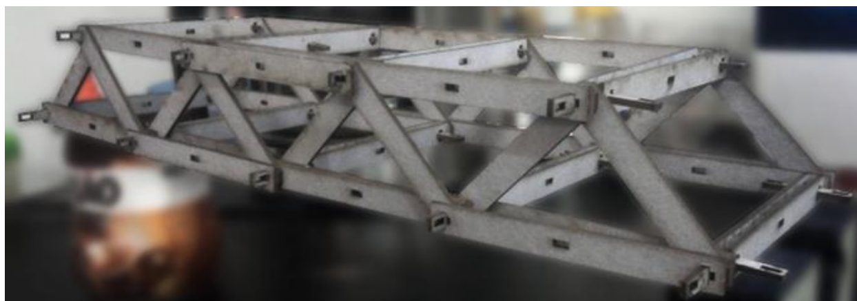
Figura 88 Protótipo de papel paraná de um sistema de treliças de tábuas de pallet intertravadas por peças de madeira fresadas. Fonte: elaborada pelo autor.
