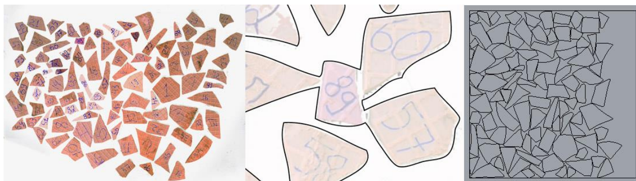
Figura 73 Processo de vetorização e organização dos retalhos de ladrilho. À esquerda a foto tratada de maneira a ter o maior contraste figura-fundo. No centro um exemplo de má vetorização devido à proximidade
