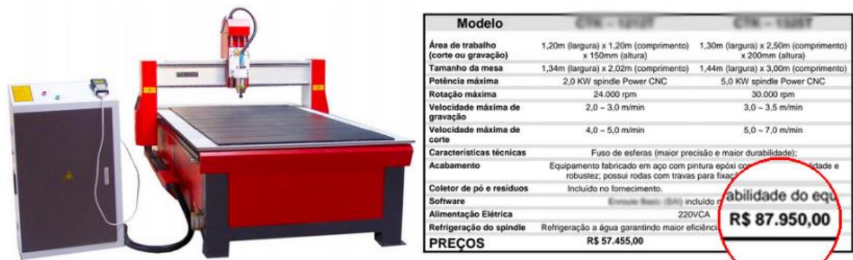
Figura 36 Orçamento de uma fresadora de três eixos com movimentação de 250x130x15cm e um motor de 5kw (potência suficiente para girar fresas grandes que proporcionam velocidade ao trabalho) feito em 2013. Fonte: orçamento, feito via email , de uma máquina chinesa importada e montada no Brasil por empresa brasileira.
