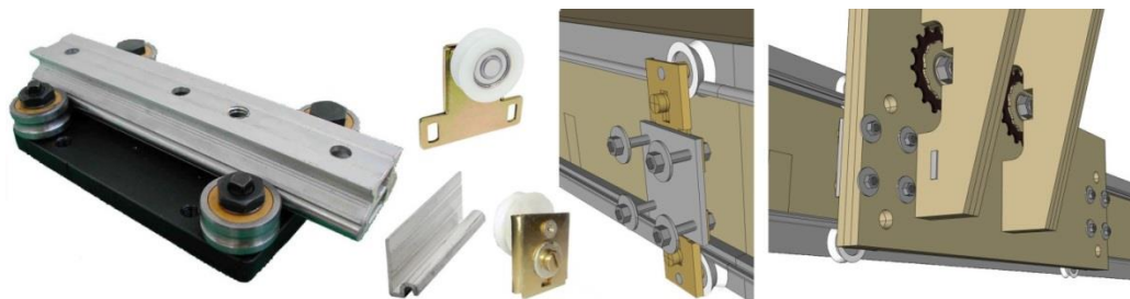
Figura 45 À esquerda sistema de movimentação linear faça-você-mesmo mais eficiente que o sistema de patins, apesar de um pouco mais caro devido ao custo dos rolamentos côncavos. Ao centro uma opção de rolamento côncavo mais barato, utilizado em portas de correr, que já contém um sistema de ajuste embutido. À direita a um exemplo da aplicação do rolamento côncavo na máquina. Fonte da imagem à esquerda: Site CNCZONE – DIY cnc machines blog 46 . Fonte das demais imagens: elaboradas pelo autor.
