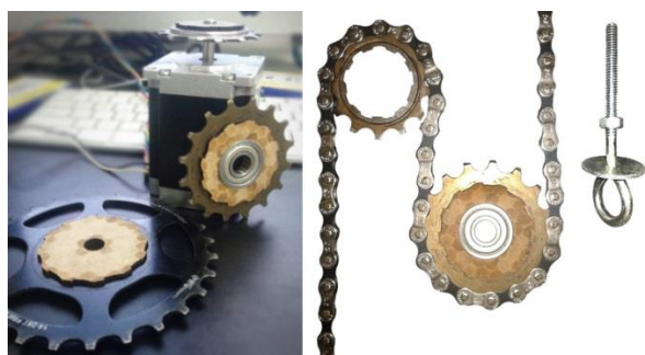
Figura 44 Catracas de bicicleta adaptadas utilizando peças cortadas a laser a partir de chapas de MDF de seis milímetros. O encaixe exato entre as peças foi obtido através da digitalização das catracas utilizando um scanner . Fonte: elaborada pelo autor.
