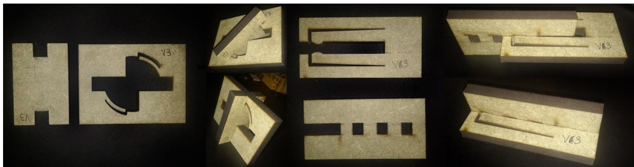
Figura 82 Encaixes de plugar e desplugar prototipados a partir do manual “50 digital wood joints” de Jochen Gros. O segundo encaixe demonstrado também foi prototipado em sua versão fixa, a qual tem uma ponta quadrada no lugar da redonda. Fonte: elaboradas pelo autor.
