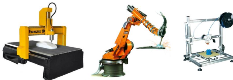
Figura 17 Máquinas de fabricação digital. À esquerda uma fresadora, ao centro um braço robótico de corte, e à direita uma impressora 3D. Fonte: elaborada pelo autor.
