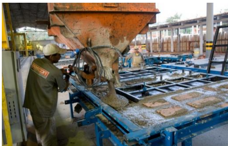
Figura 47. Painel de vedação utilizado para edificações do MCMV
