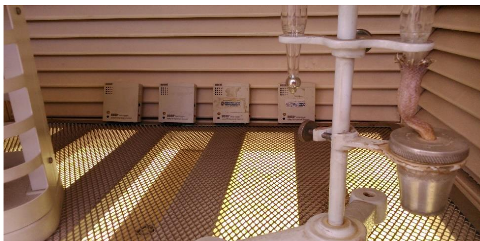
Figura 15 - Aferição dos HOBOS com a estação meteorológica-padrão
