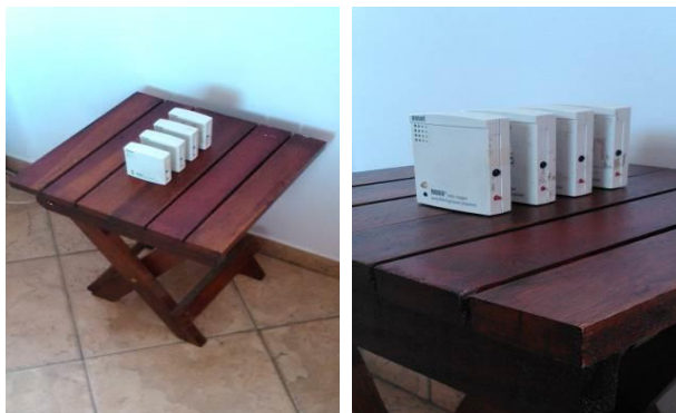
Figura 14 - Aferição dos HOBOS em ambiente fechado.
