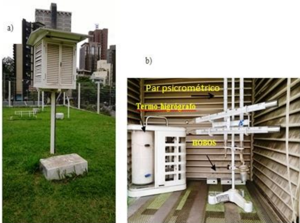
Figura 67 - Aferição dos dataloggers HOBO no 5°DISME/INMET. a) Abrigo (vista exterior); b) O abrigo (vista interna)
