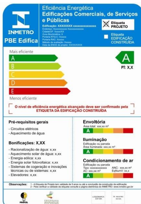
Figura 2: Exemplo de ENCE para edificação comercial, de serviço e pública (método prescritivo), Etiqueta de projeto.
