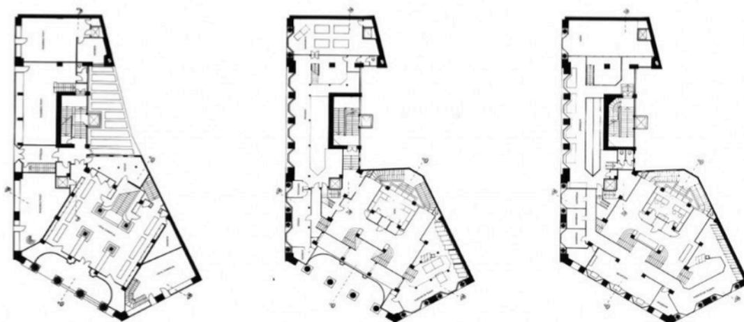
Fig. 08. Plantas da área comercial, pavimento térreo e a evolução até o terceiro pavimento, marcado por ambientes com diversos níveis de cotas, característica da *Rauplan*.
