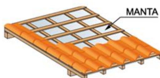
Figura 29 - Instalação manta térmica
