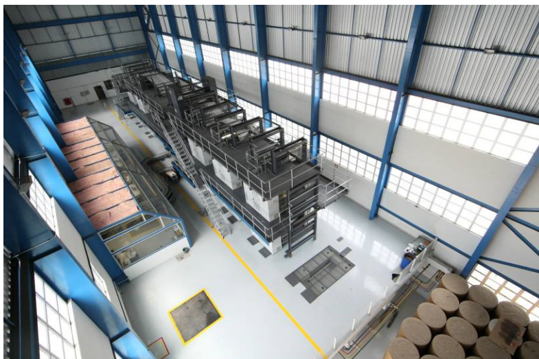
Figura 7: Vista da área de produção – galpão – Cômodo Nova Rotativa. No nível superior, máquina de produção no centro, sala de controle à esquerda. No nível inferior, bobinas de papel
