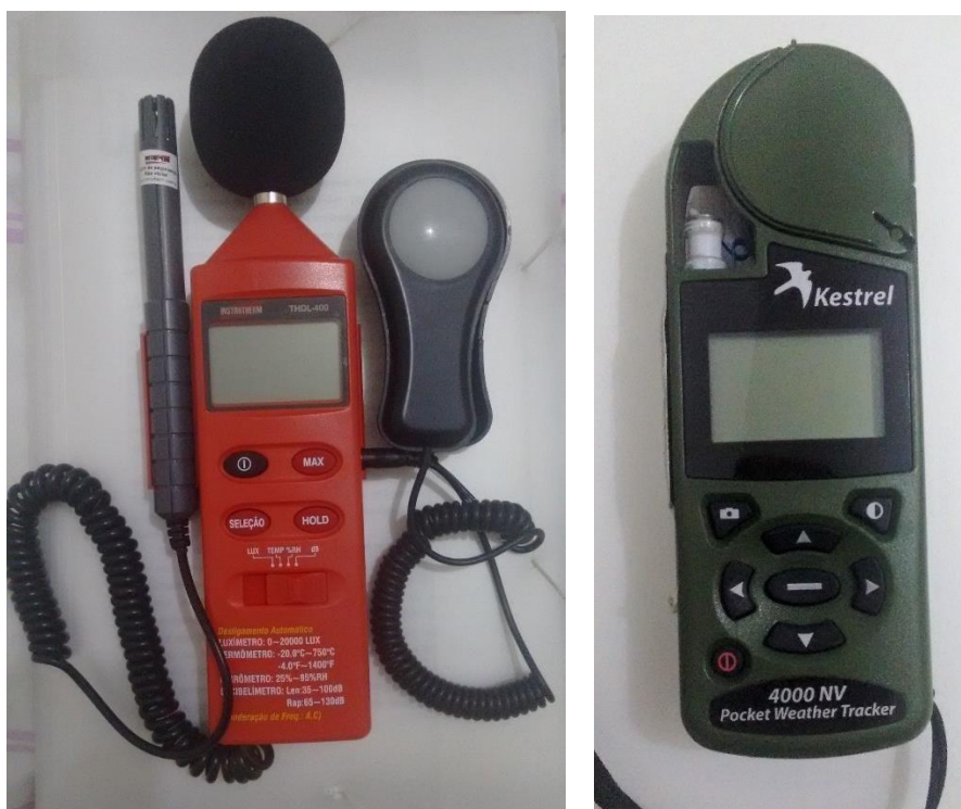
Figura 9 - Instrumentos de medição: Termo-Higro-Decib-Lux, modelo Instrutherm THDL-400 (esquerda) , e um anemômetro, modelo Kestrel 4000 NV (direita).
