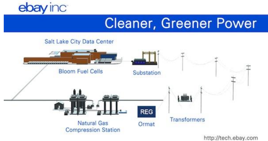
Figura 6 - Sistema de fornecimento de energia do Data Center do Ebay, em Utah. (Fonte: Forbes, 2016)
