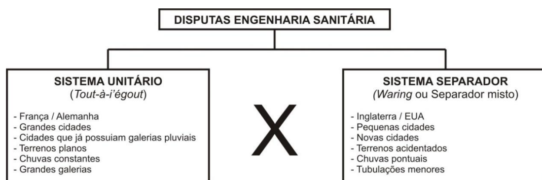
Figura 78 – Diagrama das disputas no campo da engenharia sanitária, entre os sistemas unitário e separador. Fonte: SCHLADWEILER, 2004. Adaptado pelo autor.
