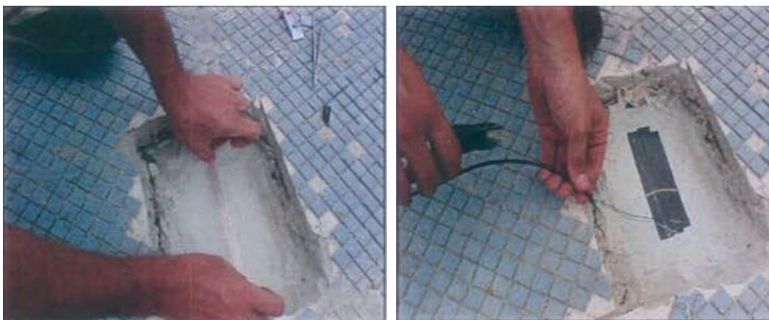
Figuras 50 e 51 - Fixação dos filamentos de Strain Gages na estrutura. Fonte: IPHAN/MG.
