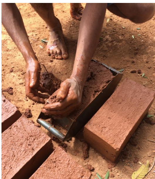
Figura 14 – Uniformização da superfície do bloco com as mãos. Lapinha da Serra – MG.
