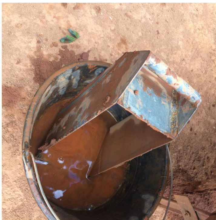
Figura 28 – Forma de metal para produção de adobe em Lapinha da Serra.
