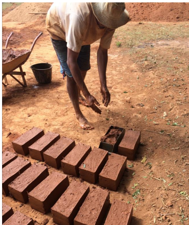
Figura 13 – Produção do bloco de adobe com preparação diretamente no colo em forma metálica individual. Lapinha da Serra – MG.
