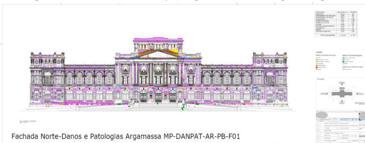
Figura 89 – Levantamento das patologias. Com base na grelha digital.
