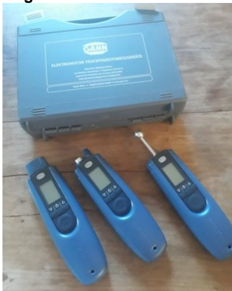
Figura 135 – Termo-Higrômetros eletrônicos utilizados nos ensaios.
