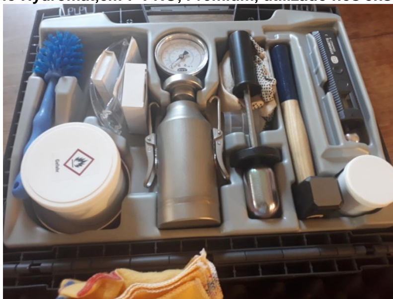
Figura 136 – O equipamento para o Teste ao carboneto de marca GANN, modelo Hydromat,cm-P PRO, Premium, utilizado nos ensaios.
