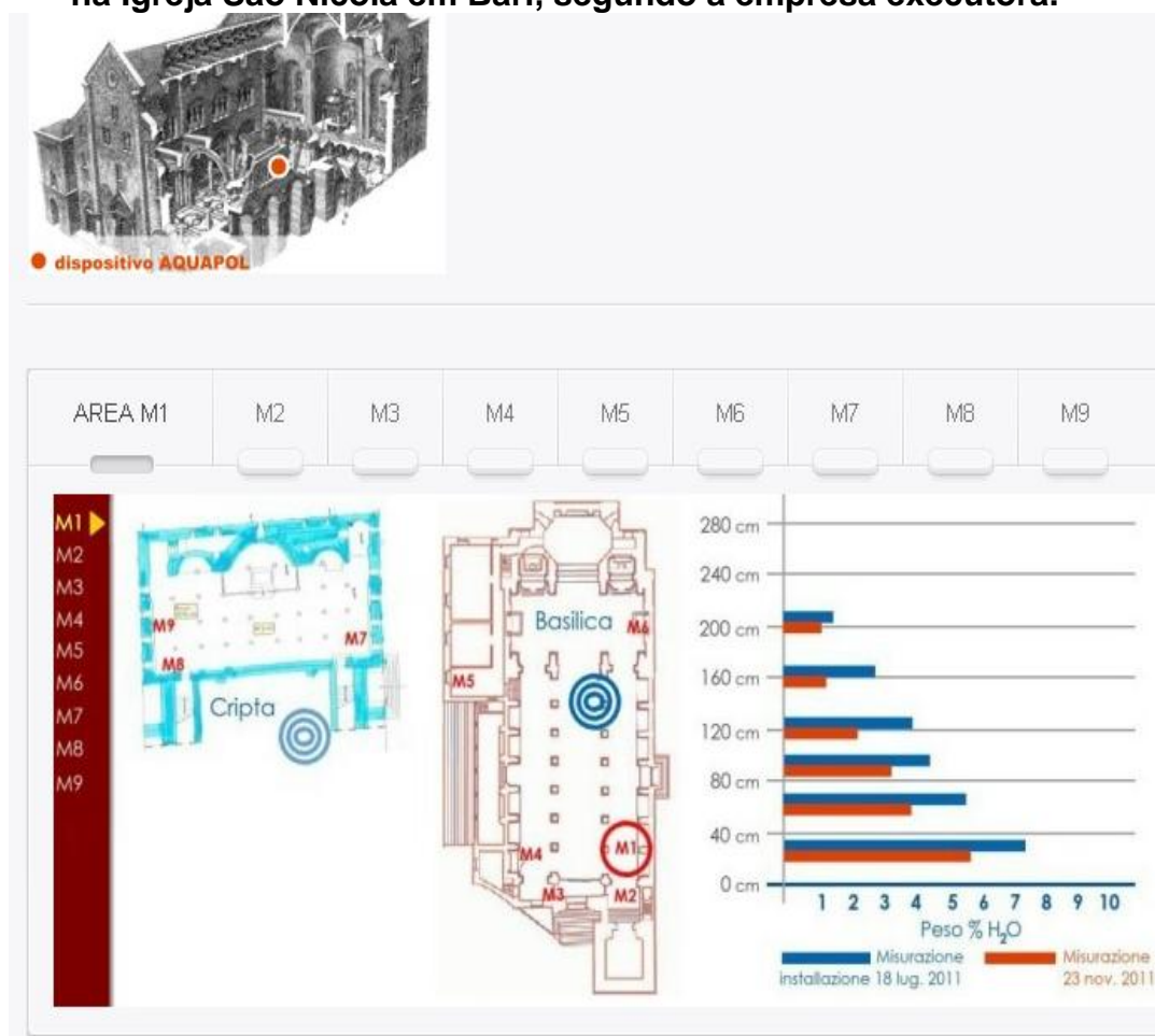
Figura 124 – A experiência do monitoramento da eficácia do sistema aplicado na Igreja São Nicola em Bari, segundo a empresa executora.
