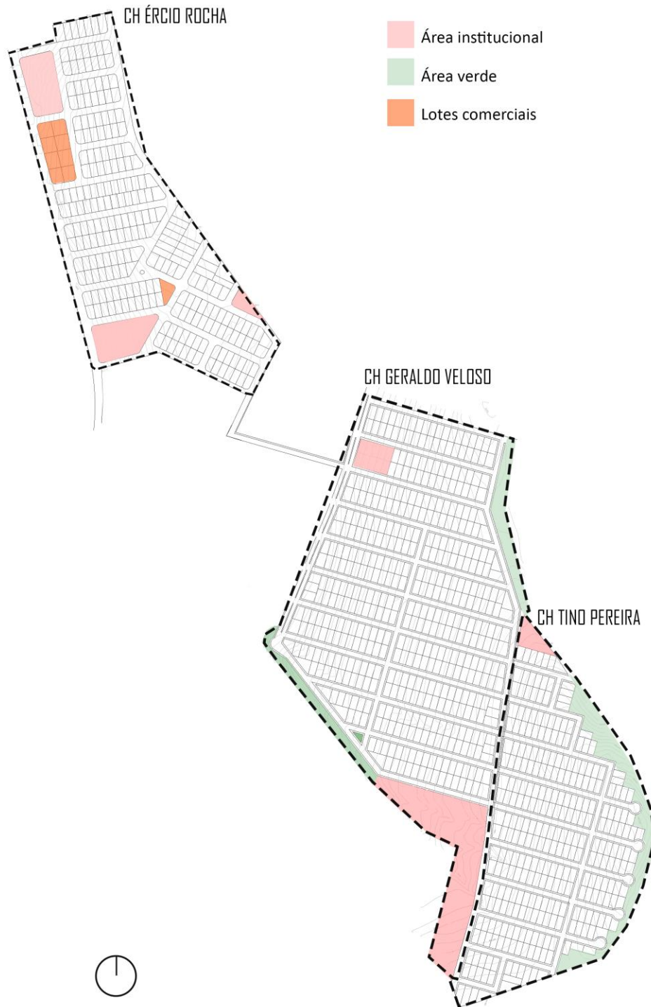
Figura 46: Projeto urbano conjuntos em Formiga, destaque para áreas institucionais, áreas verdes e lotes comerciais.
