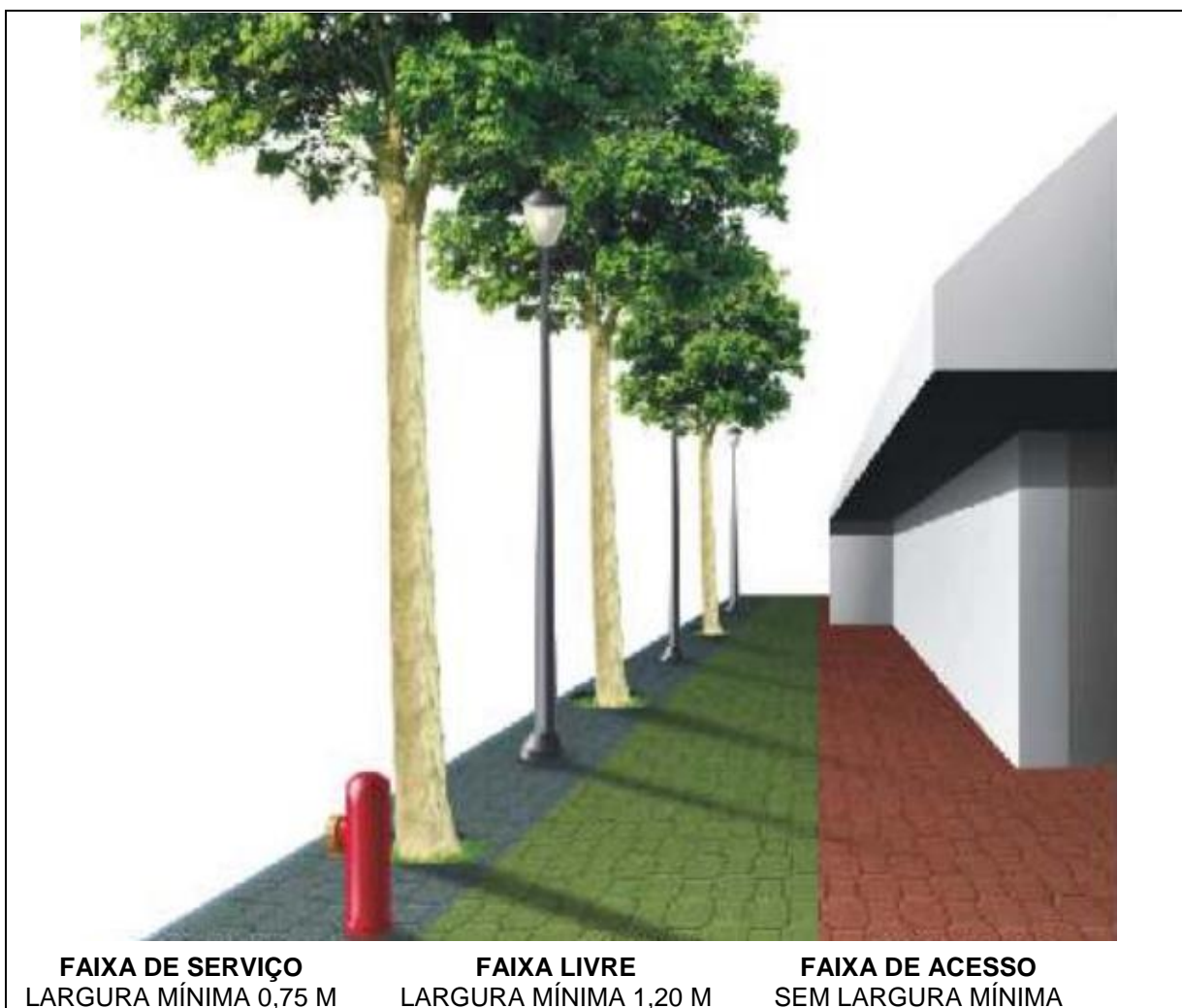
Figura 26 – Desenho da Calçada - Dimensões Mínimas
