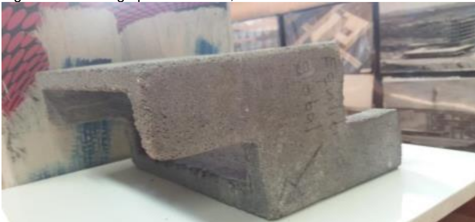
Figura 27 – Cobogó padrão UFMG, criado em 1956.
