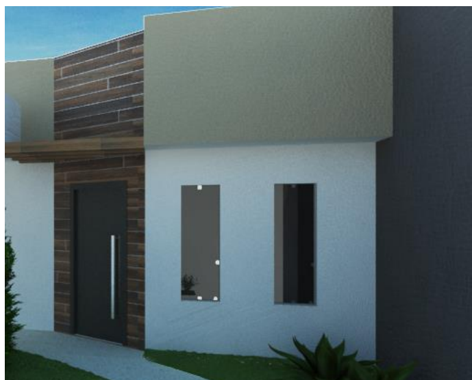
Figura 19 - Janelas pivotantes verticais
