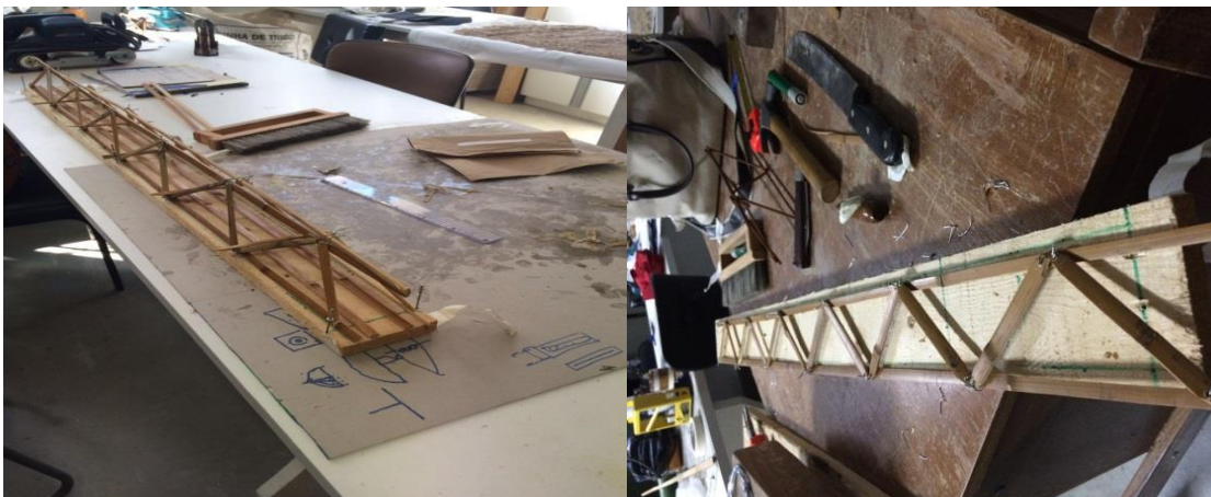
Figura 10- (a) Treliça para lajes pré-moldadas desenvolvida a partir de (b) Planos independentes.
