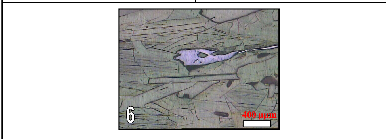
Fotomicrografia 4- Xisto peraluminoso evidenciando a orientação da granada, cianita e estaurofita. Luz transmitida, nicóis descruzados, aumento de 50 vezes (lâmina DL-15B); Fotomicrografia 5- Granada em equilíbrio com biotita + cianita no xisto peraluminoso. Luz transmitida, nicóis descruzados, aumento de 50 vezes (lâmina Q-14); Fotomicrografia 6- Ilmenita hipidioblástica com inclusão de biotita no xisto peraluminoso. Luz refletida, aumento de 50 vezes (lâmina Q-14).
