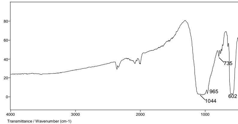
Figura 4 – Espectro de infravermelho de fluorapatita. Ausência de bandas entre 3600-3500 cm<sup>-1</sup> indicam deficiência em OH<sup>-</sup>.
