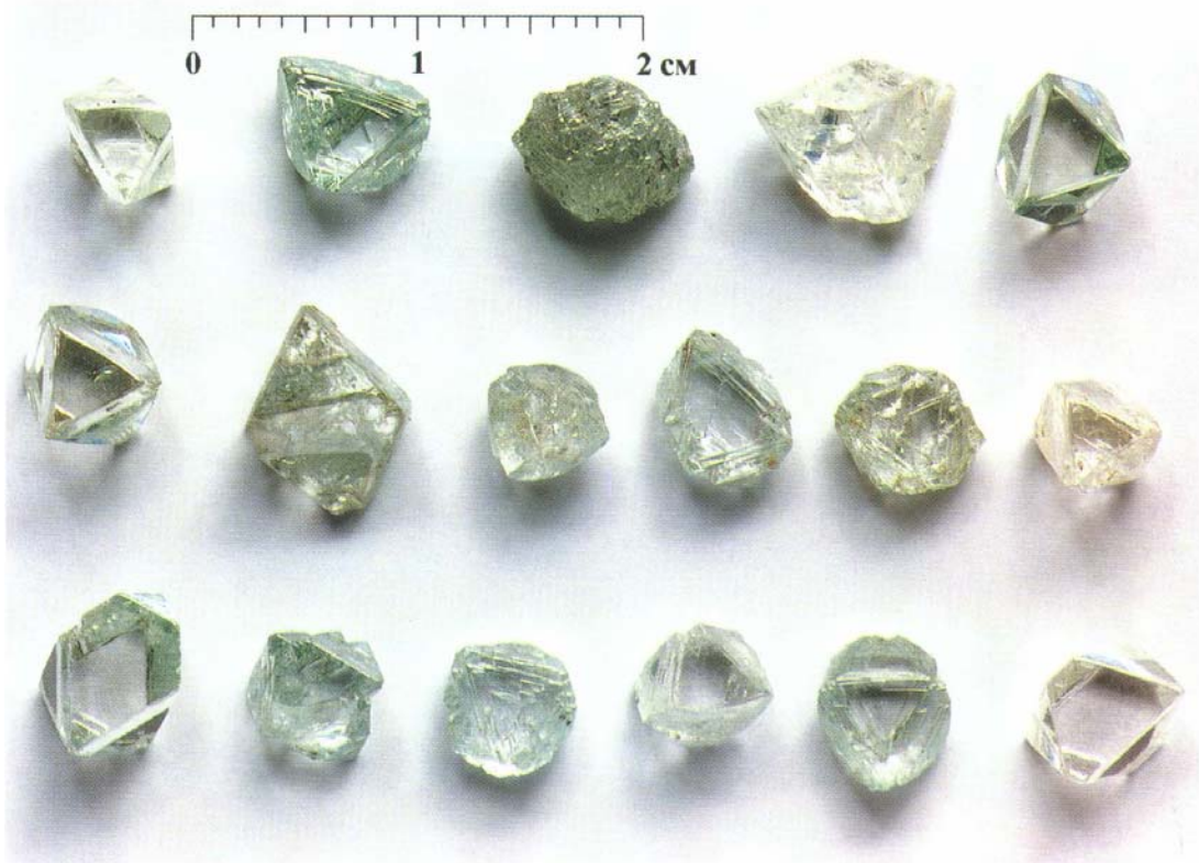
Figura 101 – Hábitos cristalinos mais comuns dos diamantes extraídos de um dos pipes kimberlíticos da Cia. ALROSA Ltda, Arkhangelsk, Rússia (retirado de Zintchouk & Koptil’ 2003).
