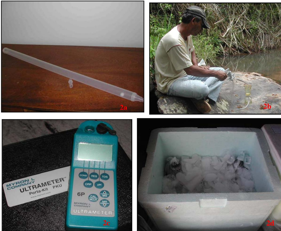
Figura 02: Equipamentos de campo (a) garrafa amostradora; (b) sistema de filtração; (c) medidor multi-parâmetro; (d) caixas de isopor e gelo para transporte de amostras de água.
