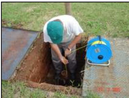
Figura 4.10 – Medição do nível da água no poço Coronel Belchior Godoy, com a utilização do medidor de nível elétrico. Fonte: (Velásquez *et al.* 2006).
