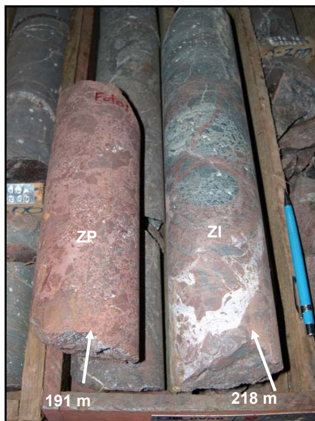
Figura 4.1 - Rocha vulcanoclástica mostrando o avanço progressivo da alteração hidrotermal. ZP: zona proximal, ZI: zona intermediária. Amostra NSSF771.
