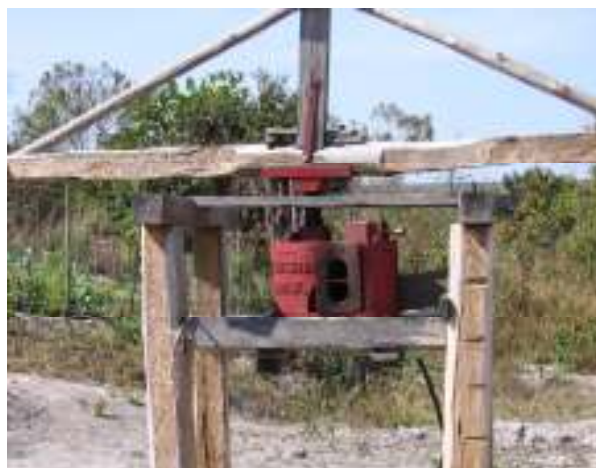
Foto 11: Engenho de ferro e “tocado à boi”, em unidade familiar na comunidade de Adrião, na região do Capivari. Fonte: pesquisa de Campo, Minas Novas, 2006.
