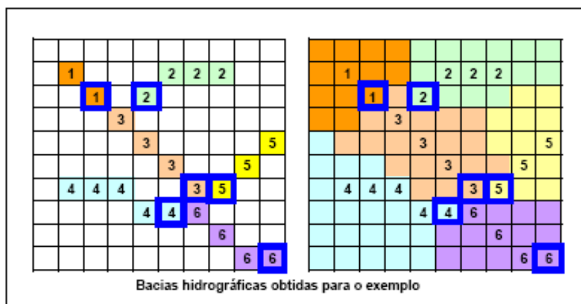
Figura 20: Bacias hidrográficas obtidas pelo método D8. Fonte: Marcellini, 2002, p. 83.
