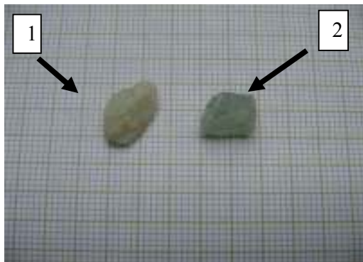
Figura 42 - Amostra de 800m (1) do sistema fluvial a 8.000m (2) obtida no tumbler (escala papel milimetrado).
