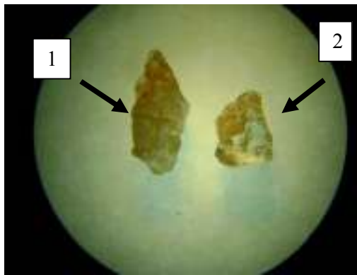
Figura 58 -Água marinha a 4.000m da Lavra do Caracol (1) e a 6.000m da Lavra da Posse (2) (escala papel milimetrado). aumento de 20 x (área iluminada de 40mm).
