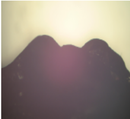
Figura 62g- Água marinha desgastada no Tumbler a 2.500m (aumento de 50x).
