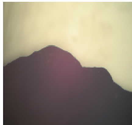
Figura 62f- Água marinha desgastada no tumbler a 2.000m (aumento de 50x).
