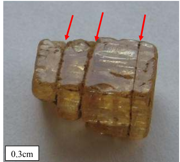
Figura 70 - Topázio a 4.000m com destaque para as linhas de clivagem (aumento de 20x).
