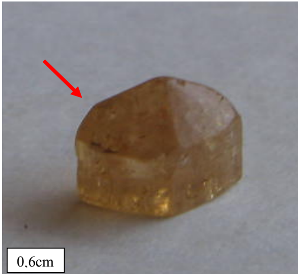
Figura 69 - Topázio a 3.000m com destaque para o desgaste da pirâmide (aumento de 20x).
