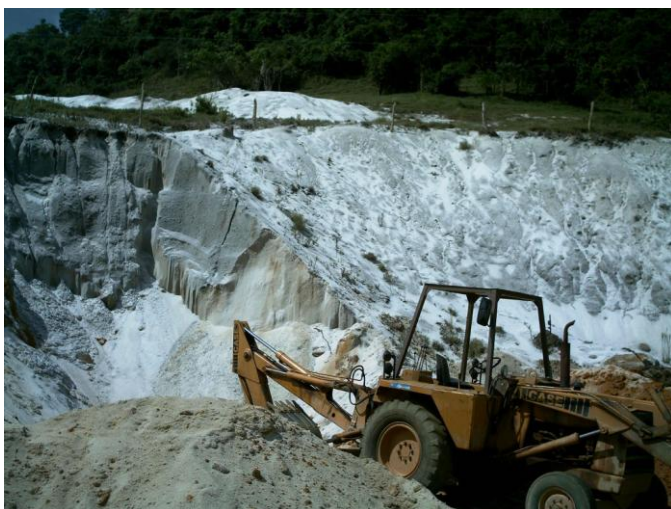
Fig.33: Máquina a extrair areia para a construção civil, diretamente de um depósito arenoso, situado nas imediações do Mogol (a 2 km da vila). Com a expansão dos empreendimentos imobiliários na Serra, o aquecimento da construção civil em Conceição de Ibitipoca demanda grande quantidade de matéria-prima para a edificação de casas e estabelecimentos comerciais, ou ainda, para subsidiar a manutenção freqüente das estradas como forma de garantir o acesso dos turistas à Serra. Em muitos casos, os próprios órgãos públicos retiram areia desses barrancos expostos, sem levar em conta a fragilidade do solo e o risco de erosão. Foto: Bruno Bedim, março 2007.
