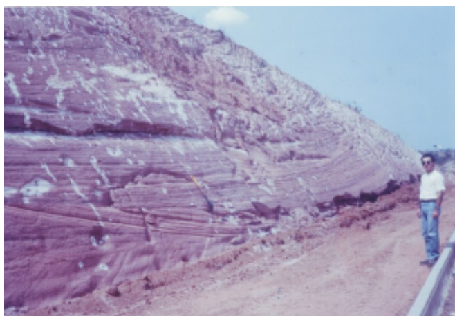
FIGURA 15 – Alterito com estrutura conservada desenvolvido de arenito da Fácies Três Barras/Grupo Areado. Pode-se observar: estratificações inclinadas e horizontais, a cor róseo-avermelhado e manchas de descoloração coincidentes com poros biológicos preenchidos com matéria orgânica. Local: Rodovia BR-040, próximo a Três Marias. Melo (1992).
