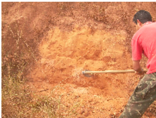
FIGURA 16 – Perfil de solo no barranco de estrada (MG-161), no Vale do Córrego Palmital, com o horizonte C 2 (representado por alterito do arenito Areado) do Neossolo quartzarênico sobre alterito de rochas sedimentares da Formação Três Marias. Buritizeiro. (jun./2006).
