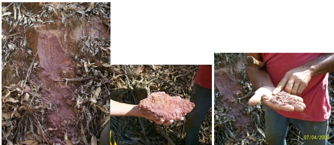
Figura 45 – Na foto inferior, Terra de Oca usada para forrar a forma de fazer tijolo. Nas fotos acima, material de origem da Terra de Oca.
