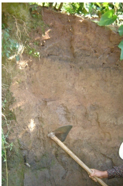
Figura 55 – Terra Roxa de Grota cujas camadas identificadas pelo agricultor são: Primeira camada ⇨ orgânica 44cm; Segunda camada ⇨ terra roxa 44 – 121cm; Terceira camada ⇨ terra roxa com moledo 121-220cm+
